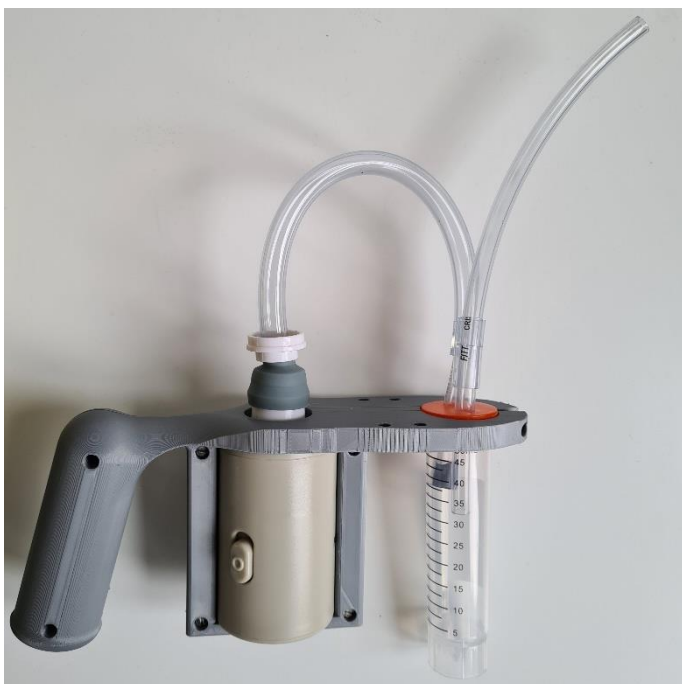
Foto 2: Mechanische aspirator voor grootschalige verzameling van insecten.
