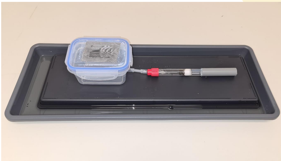
Foto 3: Experimentele opstelling met drievoudige anti-uitbraak: 1. Fluon; 2. Fijnmazig rooster; 3. Schaal met olie.
